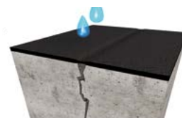
Scheuroverbruggende waterdichting: Hierbij zorgen de laagdikte en elasticiteit van de waterdichting ervoor dat deze bestand is tegen permanente waterdruk.
