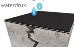
Scheuroverbruggende afdichting met wapeningsnet: Het net scheidt de bovenste afdichtingslaag van de scheur en draagt aanzienlijk bij aan het weerstaan van de permanente waterdruk.
